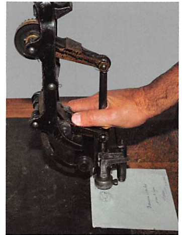
Utilisation de la machine Daguin. (Source: Musée de la Poste, Paris, photo Müller)
