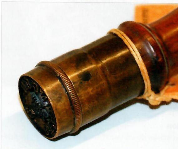
Figure 8. Détail de la bague de serrage rainurée permettant de plaquer et coincer les éléments de la date.
