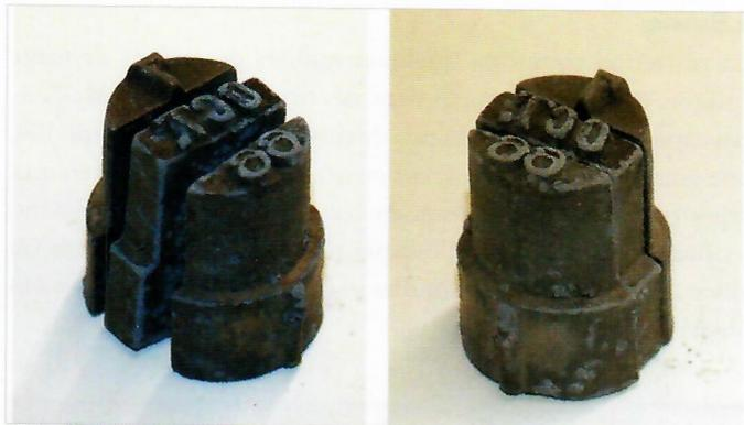
Figure 7. Exemple d'assemblage des 3 éléments constitutifs de la date, avant introduction dans la douille. On remarque une surlargeur à la base des caractères, une butée, permettant l'ajustement et évitant aux éléments mobiles de glisser hors du tampon.
