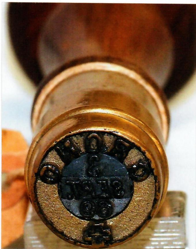
Figure 5. Couronne fixe, nettoyée, montrant une constitution en laiton.
