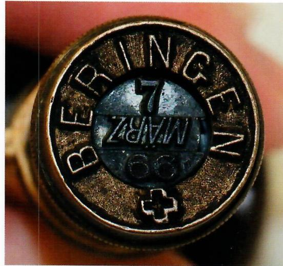
Figure 10. Image de la figure 9, inversée informatiquement, pour montrer ce que l'oblitération aurait produit. On constate qu'il n'était pas toujours facile d'introduire les caractères dans le bon sens, ce qui a produit de nombreuses oblitérations du groupe 104 avec des défauts et des inversions.
