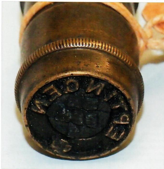
Figure 13. Exemple de timbre à date où la date est totalement illisible par suite de l'encrassement des caractères (EPTINGEN – DEC -).
