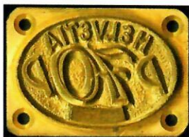
Figure 1. Cliché original en laiton à gauche et empreinte de la même valeur à droite.
